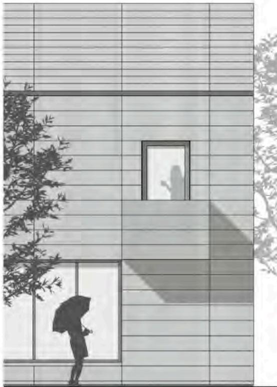
Eine echte Investition: Edelstahlsteckpaneele umhüllen einen Stahlskelettbau mit Trapezblechdecken und -dach. Die hochwertigen, langlebigen und wirtvollen Materialien sind im Rückbau vollständig auf gleicher Qualitätstufe recycelbar und somit eine Geld-zurück-Garantie.
